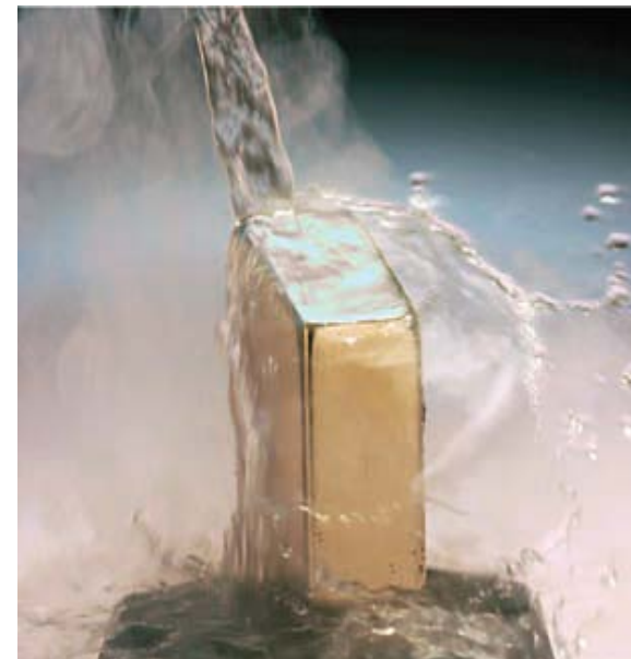
N_2 , diamagnético al contrario, no se ve atraído hacia el imán, se repele.
