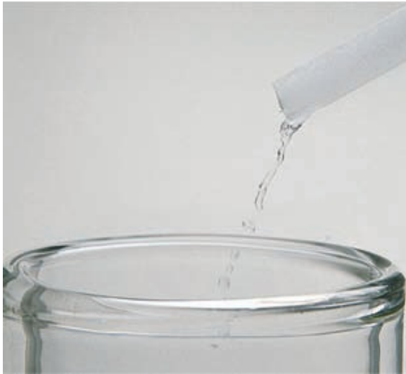
El oxígeno es licuado haciéndolo pasar x una bobina sumergida en N_2(l) T = -195.8\text{ }^\circ\text{C}
