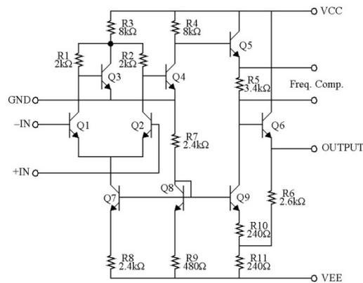
Circuito del primer amplificador operacional comercial, el  $\mu$ A702, diseñado por Bob Widlar y comercializado por Fairchild en 1964
