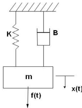
7. Dado el sistema mecánico de la figura, hallar el modelo matemático que relacione el desplazamiento  $X_2(t)$  de la masa  $M$  con respecto al desplazamiento  $X_1(t)$ .
