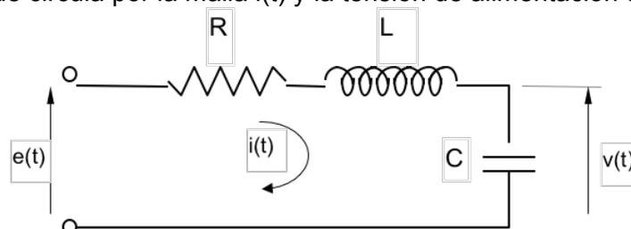
14. Sea el circuito de la figura. Cuando la impedancia de entrada del segundo elemento es infinita, la salida del primer elemento no resulta afectada por la conexión al segundo elemento. Obtener el modelo matemático que representa la relación entre las intensidades  $i_1(t)$  e  $i_2(t)$  y la tensión de alimentación del circuito  $e(t)$ .
