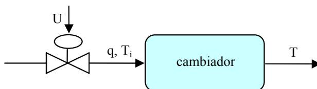
La relación de la temperatura de salida  $T$  (en  $^{\circ}\text{C}$ ) con la señal de entrada a la válvula  $U$  (en % de apertura) y con la temperatura del líquido de entrada  $T_i$  (en  $^{\circ}\text{C}$ ) viene dada por la siguiente expresión:
