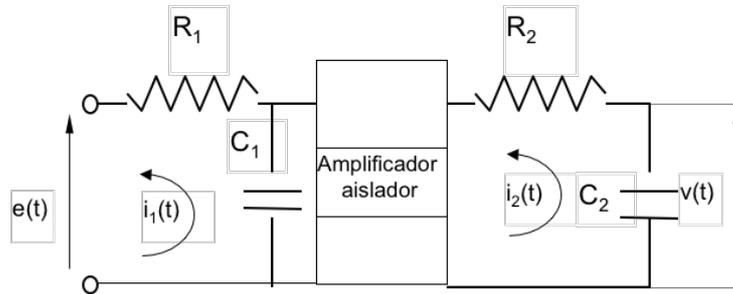
15. Sea el circuito de la figura. Obtener el modelo matemático que representa la relación entre las intensidades  $i_1(t)$  e  $i_2(t)$  y la tensión de alimentación del circuito  $e(t)$ .
