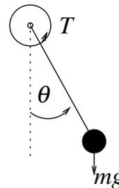
donde  $m$  es la masa de la bola,  $l$  es la longitud del brazo,  $\theta$  es el ángulo entre la vertical y el brazo,  $g$  es la aceleración de la gravedad,  $k$  es coeficiente de fricción y  $T$  el momento de par aplicado (entrada). Calcular el sistema linealizado alrededor de un punto de operación.
