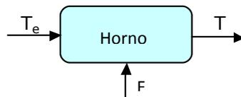
Por otro lado se sabe que la relación entre la temperatura de entrada del material  $T_e$  (°C), la temperatura de salida del material  $T$  (°C,) y el caudal de combustible  $F$  (kg/min) viene dada por la expresión:
