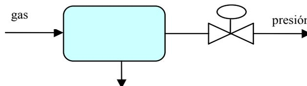
El punto de operación del sistema corresponde a una presión de 3 bar en el depósito de almacenamiento, cuando la señal a la válvula es del 30 %. La presión en el interior
