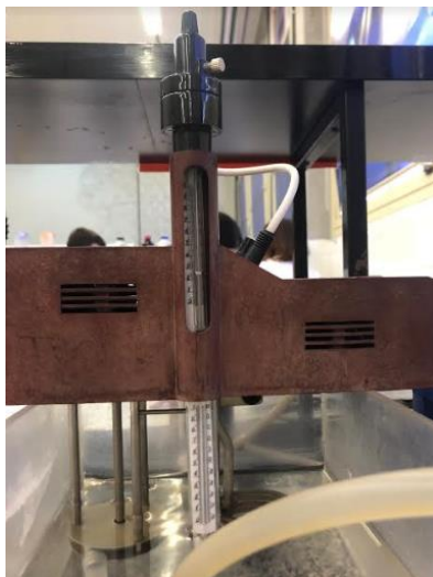
2. Irudia. Bainu termostatikoaren temperatura kontrolatzen duen termometroa.
