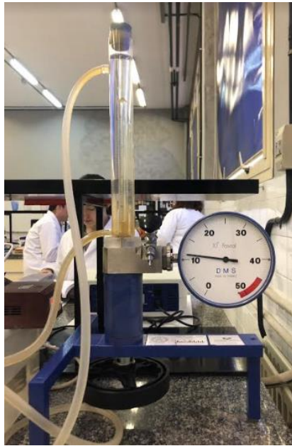
4. Irudia. Bolumena zehazteko erabiltzen den bolantea eta honek eragiten duen presioa adierazten duen manometroa.
