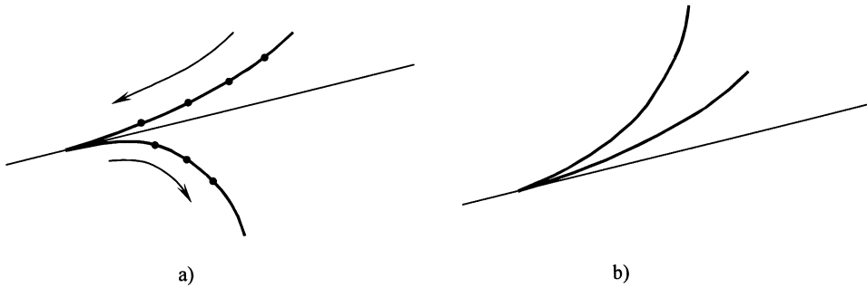
FIGURA 2.60. Puntos cuspidales de primera (a) y segunda especie (b).
