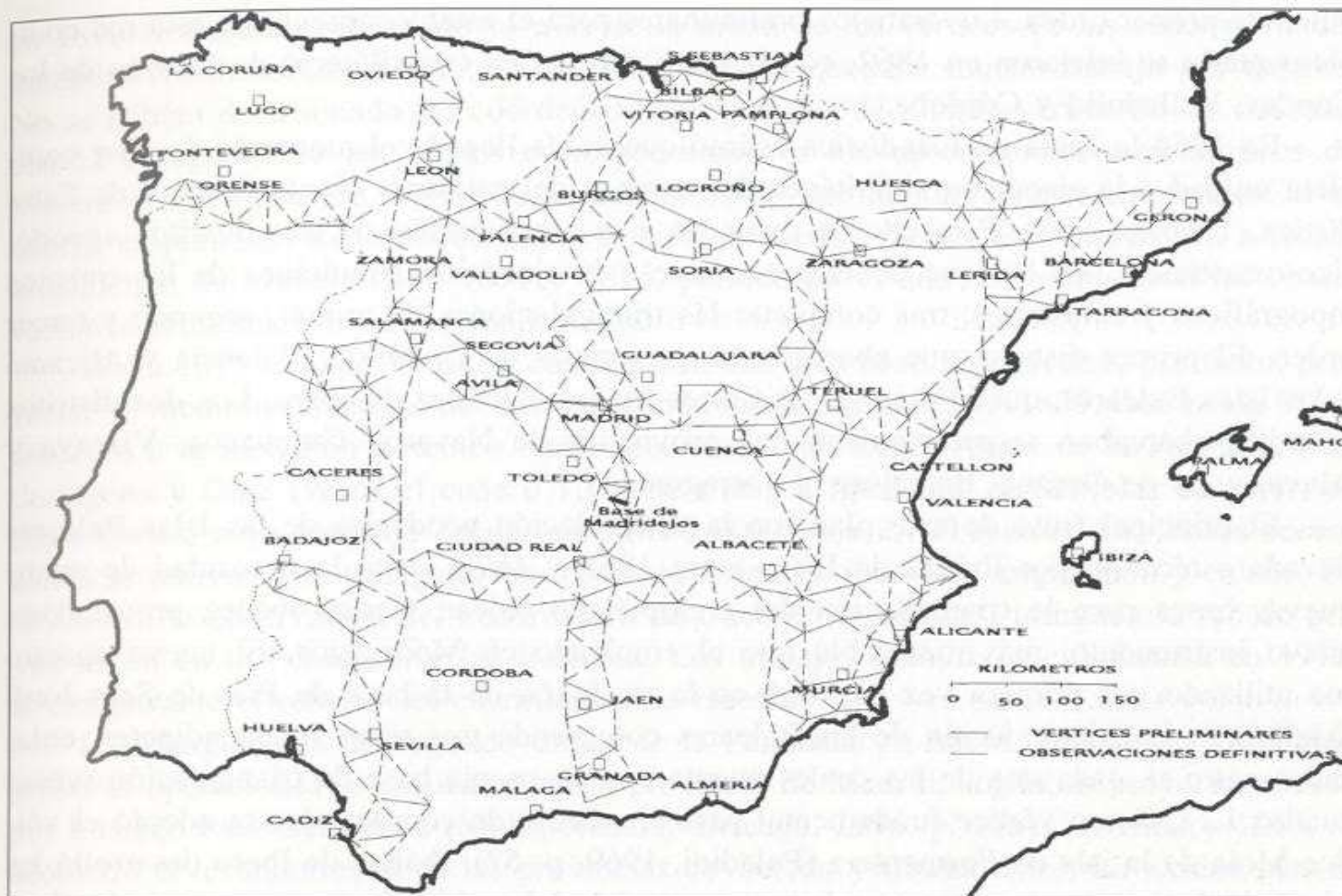
Figura 1.1. Esquema de la red geodésica de primer orden. Observaciones preliminares realizadas de 1854 a 1859. Fuente: Muro, Nadal y Urteaga, 1996.
