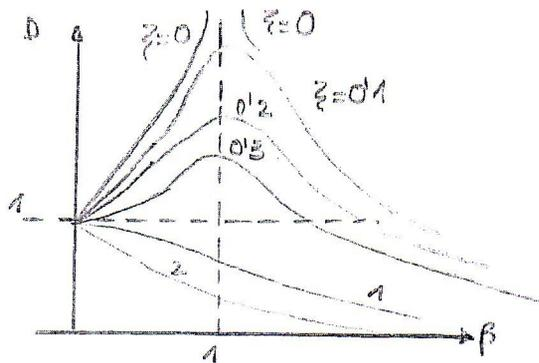
Para obtener el máximo de la curva de amplificación dinámica hacemos  $\frac{\partial D}{\partial \beta} = 0$
