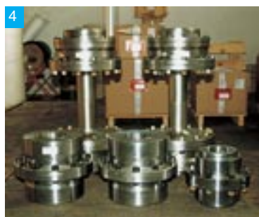
3 MT-460 especial en acero aleado y nitrurado. 4 Acoplamiento con ejes de torsión y MT especiales para la industria papelera. 5 & 6 Acoplamiento MTG-590-HD para molino de cemento. 7 MTGX-420 especial con espaciador y ajuste del posicionamiento angular. 8 Acoplamiento de dientes de gran tamaño (diámetro exterior > Ø 1800 mm) para convertidor en Acería.
