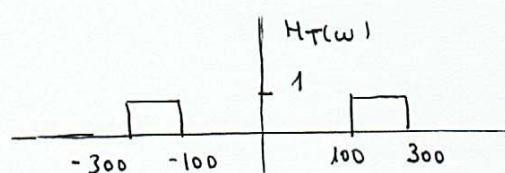
$$H_T(\omega) = H_2(\omega) \cdot H_3(\omega)$$
