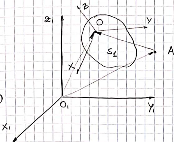
El triedro fijo ( $O_1, Z_1, Y_1, X_1$ ) es el sistema absoluto y el móvil ( $O, X, Y, Z$ ) se denomina sistema de armadura. El observador situado en el sistema fijo es el observador absoluto, y el que se encuentra en el sistema de armadura se conoce como observador móvil o relativo.
