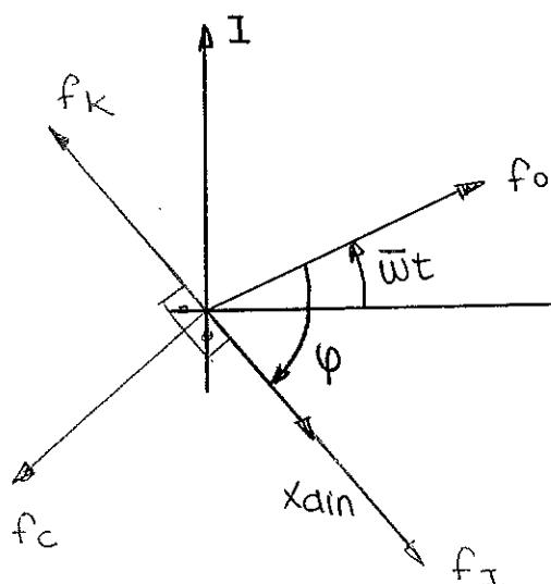
En la condición de resonancia cuando  $\varphi = \frac{\pi}{2}$ , la excitación se equilibra perfectamente con la fuerza disipativa, y la fuerza de inercia con la elástica. Por esto, cuando el amortiguamiento es muy pequeño sólo puede equilibrarse la fuerza aplicada con un desplazamiento desmesurado.
