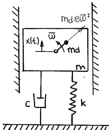
El sistema se ve sometido a una fuerza de valor:  $f_0 = m_d \cdot e \cdot \bar{\omega}^2$  que gira con una velocidad angular  $\bar{\omega}$ .
