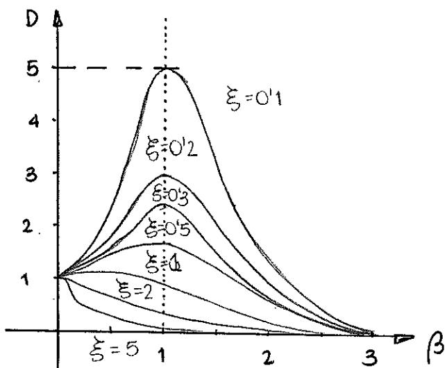
Considerando un valor habitual del amortiguamiento relativo, por ejemplo,  $\xi = 0.1$ . Para frecuencias de excitación próximas a la natural ( $\beta = 1$ ), la amplitud del desplazamiento resultante puede ser hasta cinco veces mayor que el desplazamiento estático.
