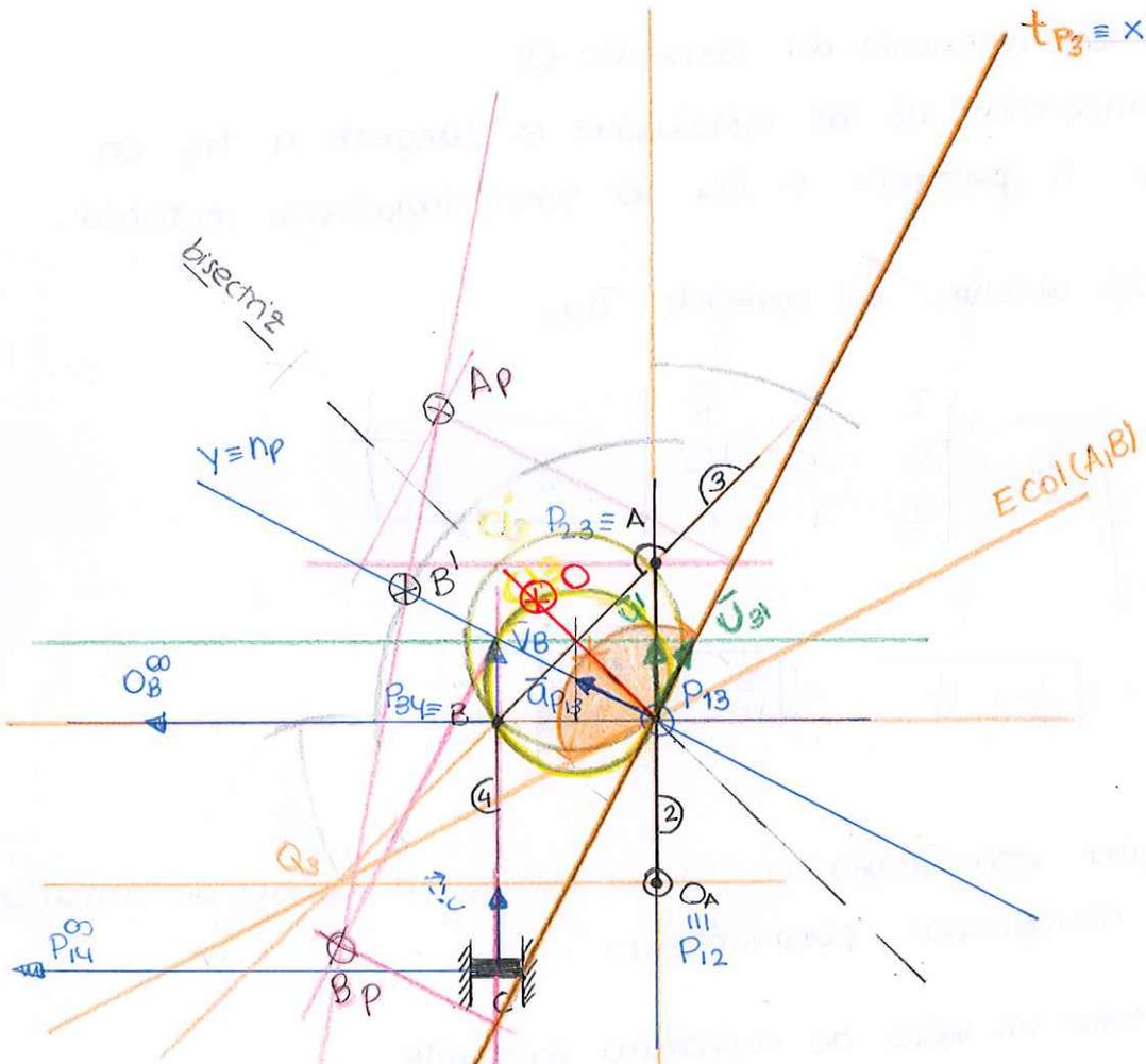
1) La tangente polar del elemento ③ aplicando el teorema de Bobillier.
