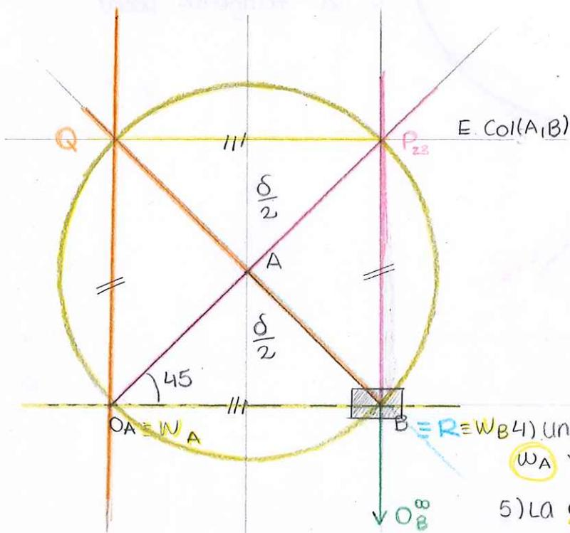
\*B describe una trayectoria rectilínea, por lo que su centro de curvatura  $O_B$  se encuentra en el infinito ( $\perp$  a  $v_B$ )
