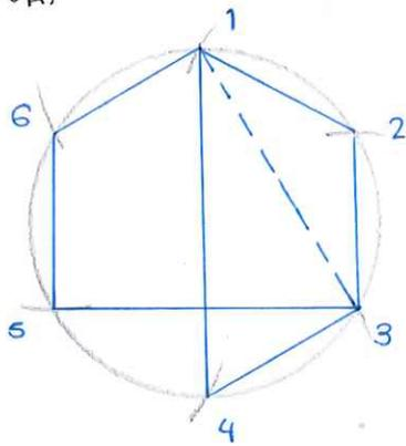
A partir del diagrama del círculo y los polos primarios obtenemos el polo  $P_{13}$
